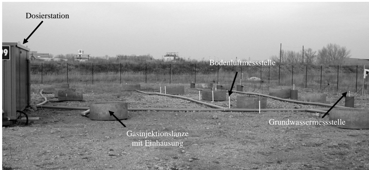
Abb. 6: Gasinjektionsfeld mit Gasinjektionslanzen, Bodenluftmessstellen und Grundwassermessstellen.
