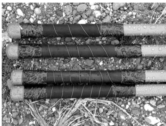
Abb. 4: a) Gazeummantelte Perforierung am Ende der PVC-U Rohre, b) Einbau der Gasinjektionslanzen am Testfeld mit Geoprobe-Technologie.
